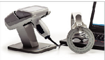
耳穴の中に型採りの材料を注入することなく、レーザーで立体的に撮影できる3Dスキャナー「オトスキャン」。
