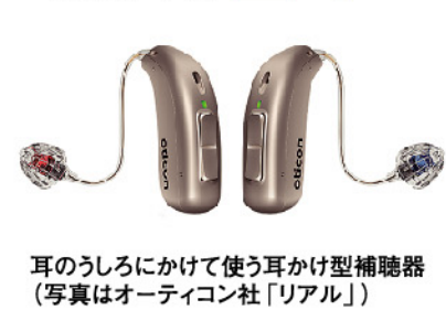
耳のうしろにかけて使う耳かけ型補聴器(写真はオーティコン社「リアル」)
