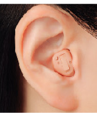
装着者の耳穴の形状に合わせてオーダーメイドで作られた耳あな型補聴器の装着イメージ(写真は標準的なサイズのカナル型)
